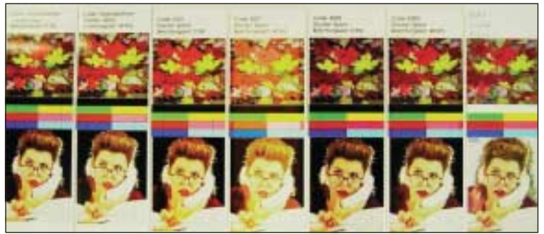
AUSLAUFEN UND AUSBLEICHEN: Nachgefüllte Patronen können beim Transport auslaufen. Spezielle Clips als Auslaufschutz gibt es ab zwei Euro. Die nachgefüllte Tinte blich in einigen Fällen bei simuliertem Sonnenlicht im Labor schneller aus als die Originaltinte. Die Druckqualität genügte in der Regel für private Nutzung.
